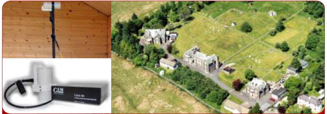
El GSM-90 Overhauser Magnetómetro instalado en la estación de observación y investigación geológica Británica (BGS) en Eskdalemuir, Sur de Escocia
